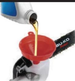
• Verter aceite de cadena en el depósito utilizando un embudo adecuado para evitar derrames y facilitar el proceso. No se recomienda usar ningún otro aceite nuevo o usado. El aceite de cadena está especialmente formulado para este propósito y es seguro para el medio ambiente.
