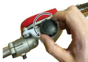
• Apriete firmemente la tapa del depósito de aceite girándola en el sentido de las agujas del reloj. Inspeccione el flujo de aceite de la cadena observando cuánto aceite se expulsa de la punta de la barra cuando el acelerador está totalmente accionado sobre un papel blanco limpio. La cantidad ideal es una fina niebla de aceite rociada sobre el papel. Si la cantidad parece insuficiente o excesiva, haga los ajustes necesarios.
