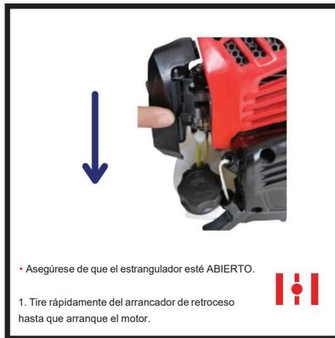
**▲ ¡ADVERTENCIA!** Evite tirar de la cuerda de arranque hasta que alcance toda su extensión y absténgase de soltar la manija cuando esté completamente estirada, ya que ambas acciones pueden provocar un desgaste prematuro del mecanismo.
