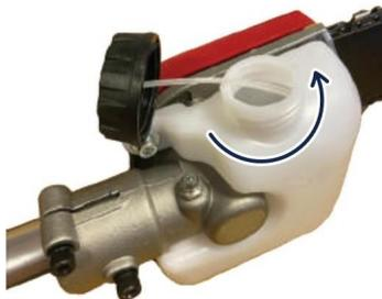
• Gire el tapón del depósito de aceite en el sentido contrario a las agujas del reloj para desmontarlo.
