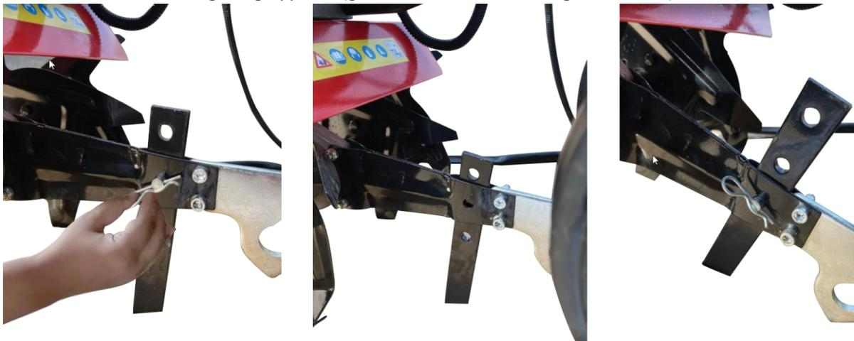
Entfernen Sie die Feder und den Bolzen
